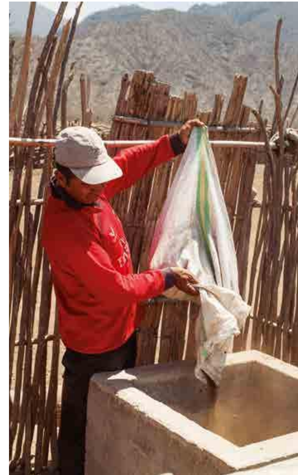
► Un biodigestor como los de Maura (debajo) y Virgilio (derecha), para empezar a funcionar precisa una primera carga de 900 kilos de estiércol y 3.600 litros de agua.
